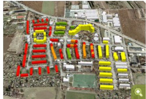
Wärmebedarfssimulation mit 3D Stadtmodell © HFT Stuttgart
