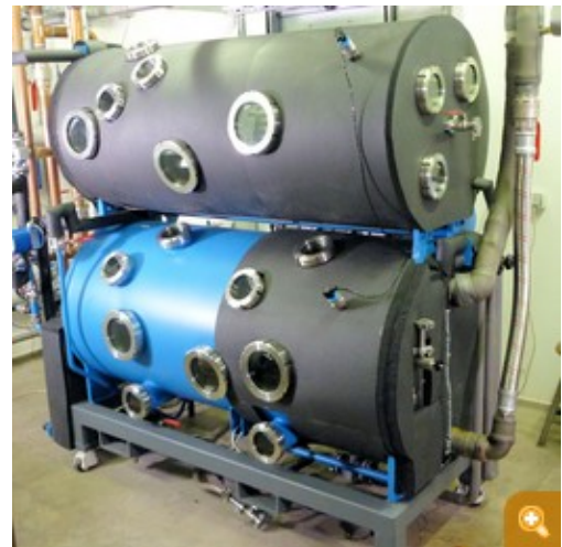
Prototyp der 50 kW-Absorptionskälteanlage © TU Berlin
