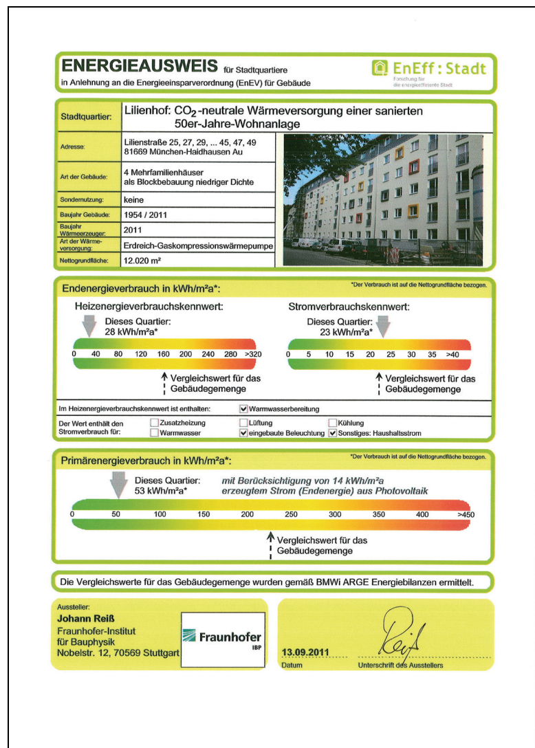
Bild 2: Der vom Fraunhofer IBP im Rahmen der Begleitforschung der BMWi-Forschungsinitiative EnEff:Stadt entwickelte Energieausweis für Stadtquartiere zeigt, dass das Münchner Vorhaben eine hohe Energieeffizienz und einen deutlich niedrigeren Primärenergiebedarf aufweist als vergleichbare Wohnanlagen in Deutschland.
